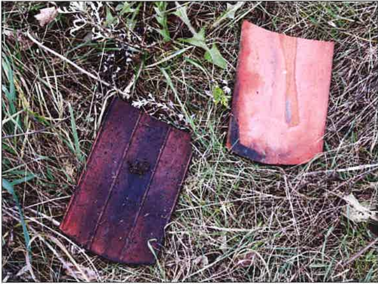
Dachówki karpiówki, widok wierzchniej i spodniej strony dachówek. (fot. Jakub Andrzejewski, 2021 r.)
